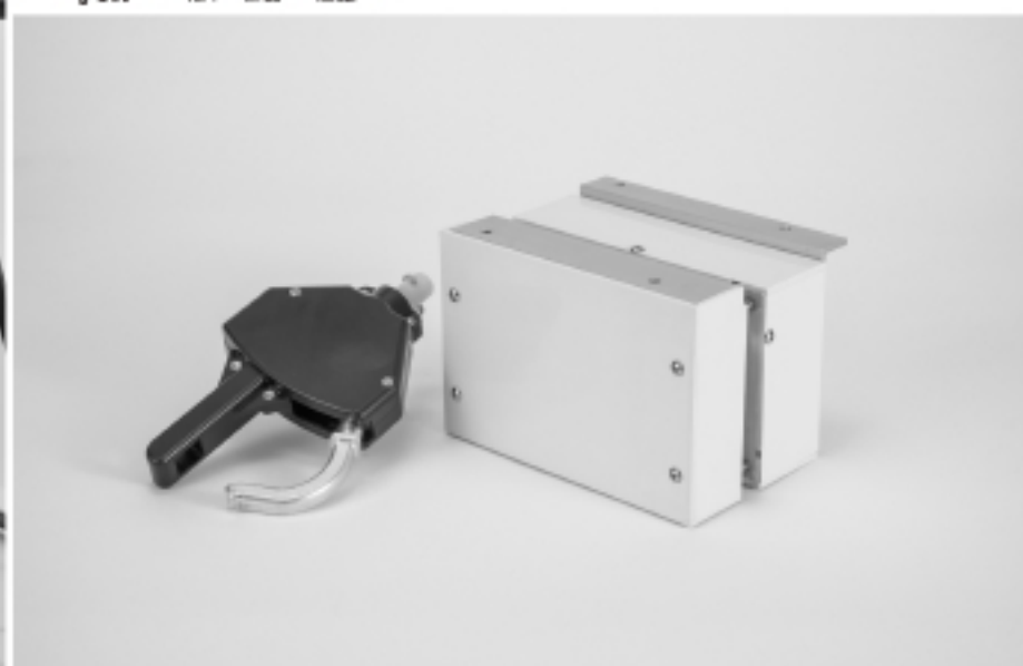
ウィンチリールフック 「D-ACT:RESCUE」(防災分野)では、山岳地帯など、ドローンが着陸できないシーンを想定して開発。ドローンがホバリングした状態でリールでフック部分が下降し荷物を降ろす。メカ機構で開閉するフック部分にも、同社技術が活かされている 同製品は、秋田県大館市で開催された杉の苗木運搬実証試験において、苗木運搬に活用され、苗木7~8kgを約300m離れた傾斜地に運搬した
