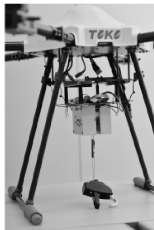
ウィンチリールフック 「D-ACT:RESCUE」(防災分野)では、山岳地帯など、ドローンが着陸できないシーンを想定して開発。ドローンがホバリングした状態でリールでフック部分が下降し荷物を降ろす。メカ機構で開閉するフック部分にも、同社技術が活かされている 同製品は、秋田県大館市で開催された杉の苗木運搬実証試験において、苗木運搬に活用され、苗木7~8kgを約300m離れた傾斜地に運搬した
