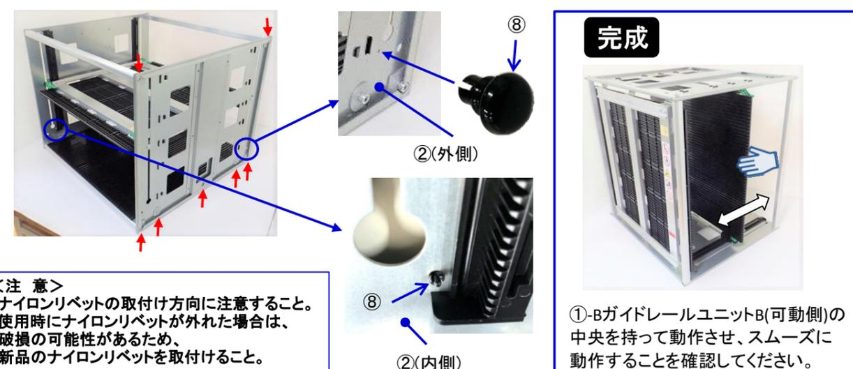
ねじ締め工具: 六角レンチ(二面幅5mm)、締め付けトルク:  $2.70 \pm 0.25 \text{N} \cdot \text{m}$  (2.45~2.95N·m)
