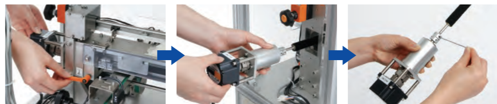
①ロックを外す ②ブラシユニットを引き抜く ③ブラシを外す
