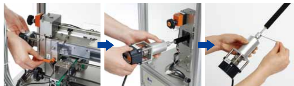
①ロックを外す ②ブラシユニットを引き抜く ③ブラシを外す
