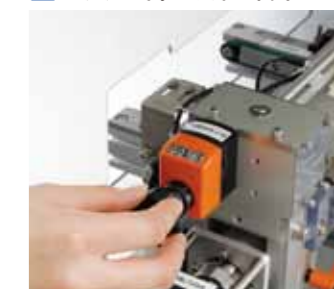
例: 基板の板厚 t1.6mm の場合は [0016] に設定
